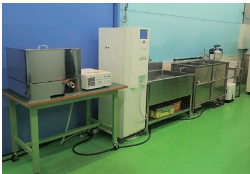
▲超音波洗浄機・超純水発生装置
