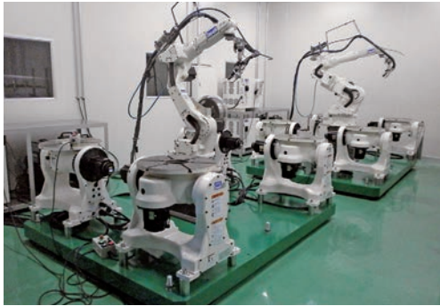
▲TIG 溶接ロボット+ポジションナ(ロボット1台につき各4台)
