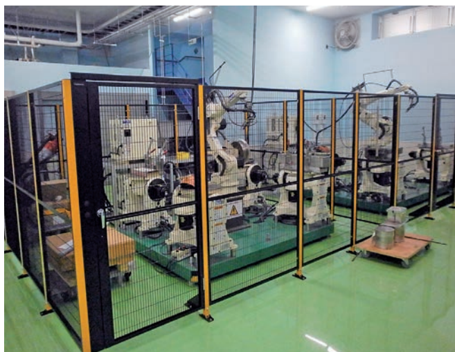
TIGロボット溶接
