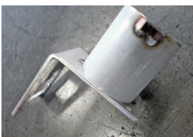
▲ファイバーレーザー溶接前 (SUS)
