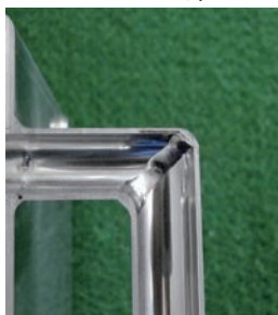
▲パイプ裏波溶接 (SUS)
