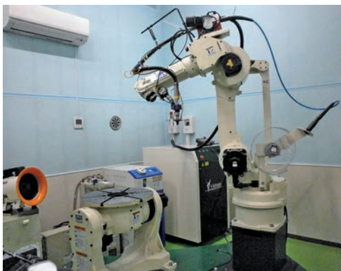
▲溶接ロボット(ファイバーレーザー用)+ポジションナ
