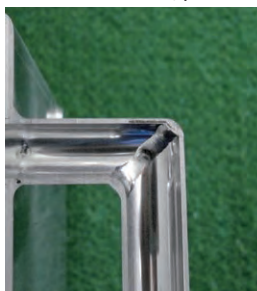
▲パイプ裏波溶接 (SUS)
