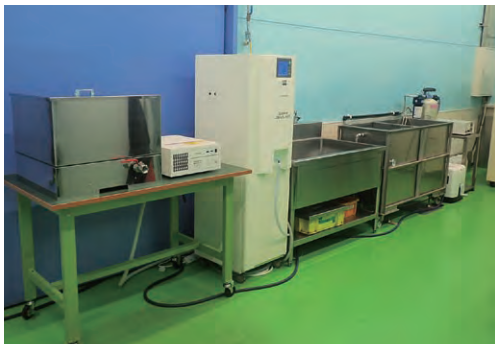
▲超音波洗浄機・超純水発生装置
