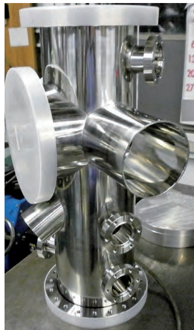
▲ICF配管 (SUS)
